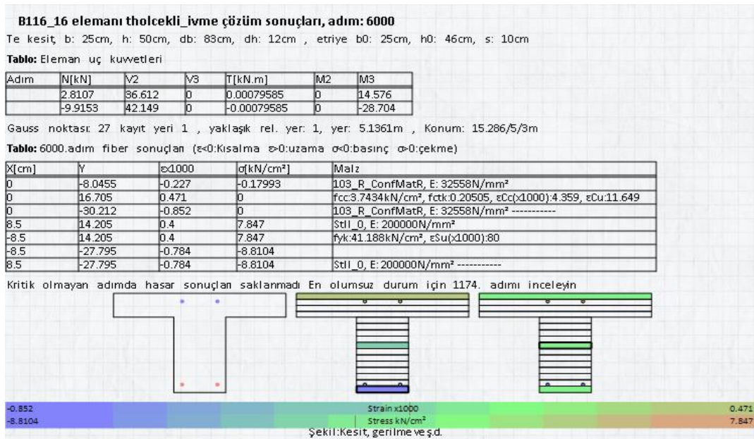
Şekil 6.33 : Kiriş malzeme ve fiber tanımı.
